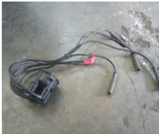
Gambar 2.17 Kabel Tegangan Tinggi
