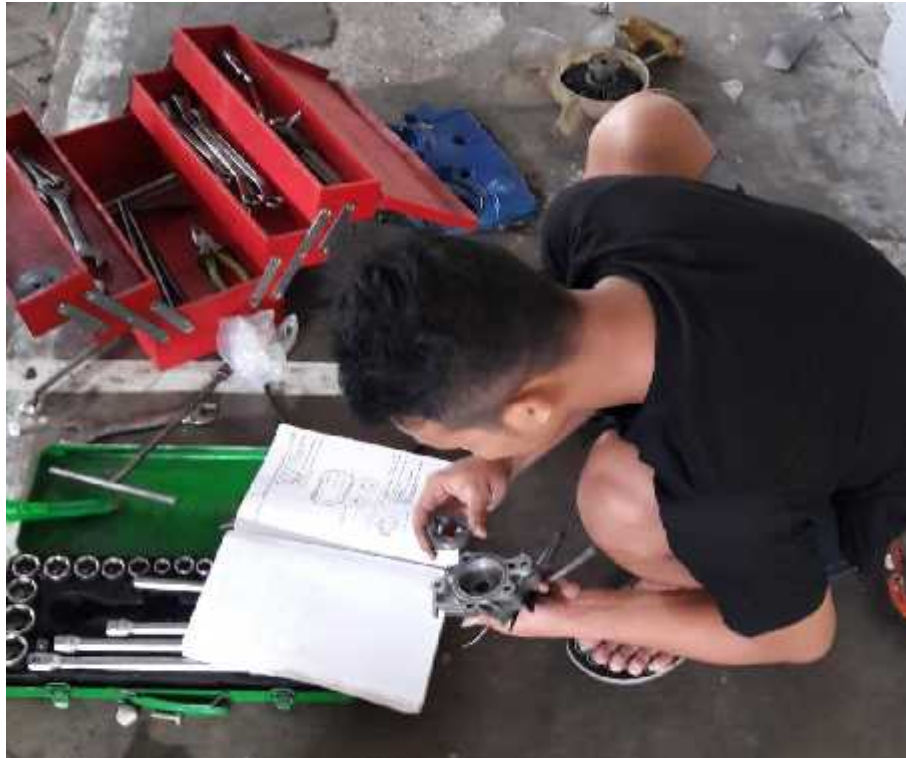
Pengecekan Pompa Oli
