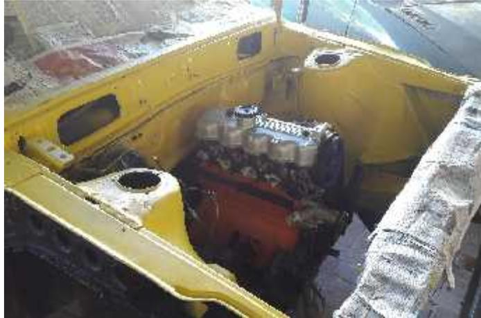
Gambar 4.35. Penempatan kembali mesin ke *Engine bay*.
