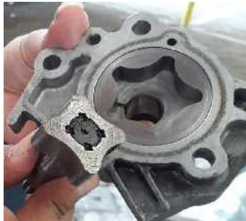
Gambar 4.27. Penggantian *driven rotor* dan *drive rotor*.
