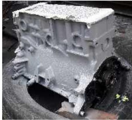
Gambar 4.30. Pengecatan cat dasar dengan epoxy.
