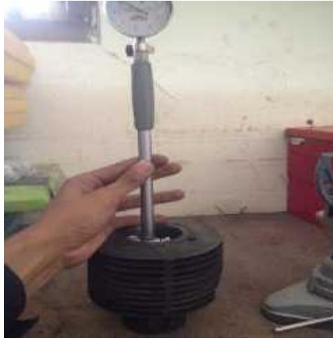
Gambar 4.15 pengukuran keovalan dengan bore gauge
