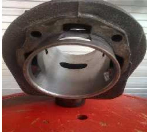
Gambar 4.17 lubang silinder yg sudah di *over size*
