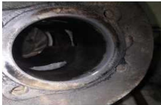
Gambar 4.18 lubang silinder sebelum di *over size*
