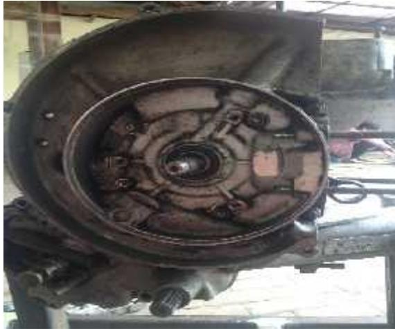
Gambar 3.8 Pelepasan Bak Mesin
