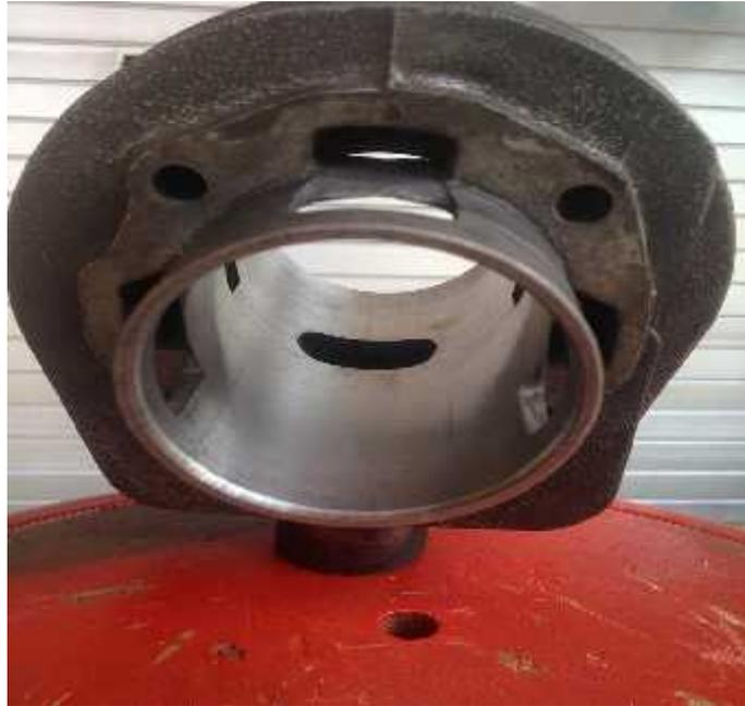
Gambar 2.11 Blok Silinder Vespa P150X
