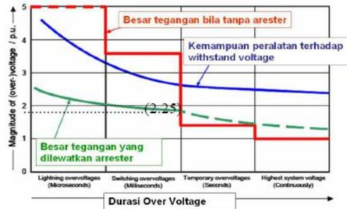
Gambar 7. Grafik level tegangan sistem yang dilewatkan menggunakan arrester dan tanpa arrester akibat sambaran petir pada peralatan gardu induk
