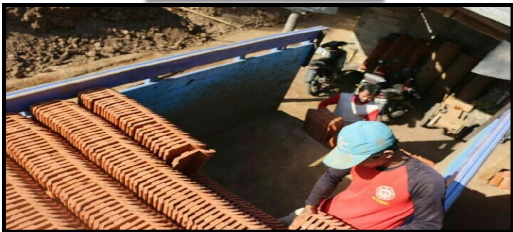
Gambar 5: Gambar diatas menunjukkan genteng yang sudah jadi dan disortir yang rusak dipisahkan, selanjutnya genteng siap untuk dijual.
