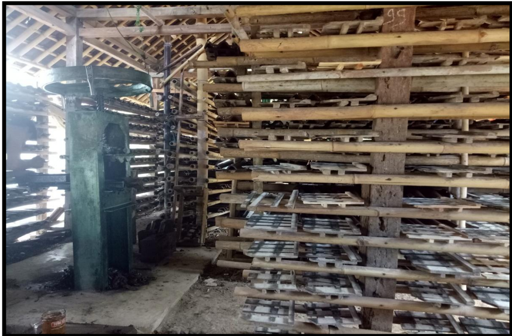
Gambar 2: Gambar sebelah kiri merupakan alat yang digunakan untuk mencetak genteng yaitu mesin press, sedangkan gambar sebelah kanan merupakan rak tempat untuk menampung genteng yang sudah dicetak dan berfungsi sebagai pengering. Di tempat rak ini genteng di angin-anginkan terlebih dahulu sebelum dijemur.
