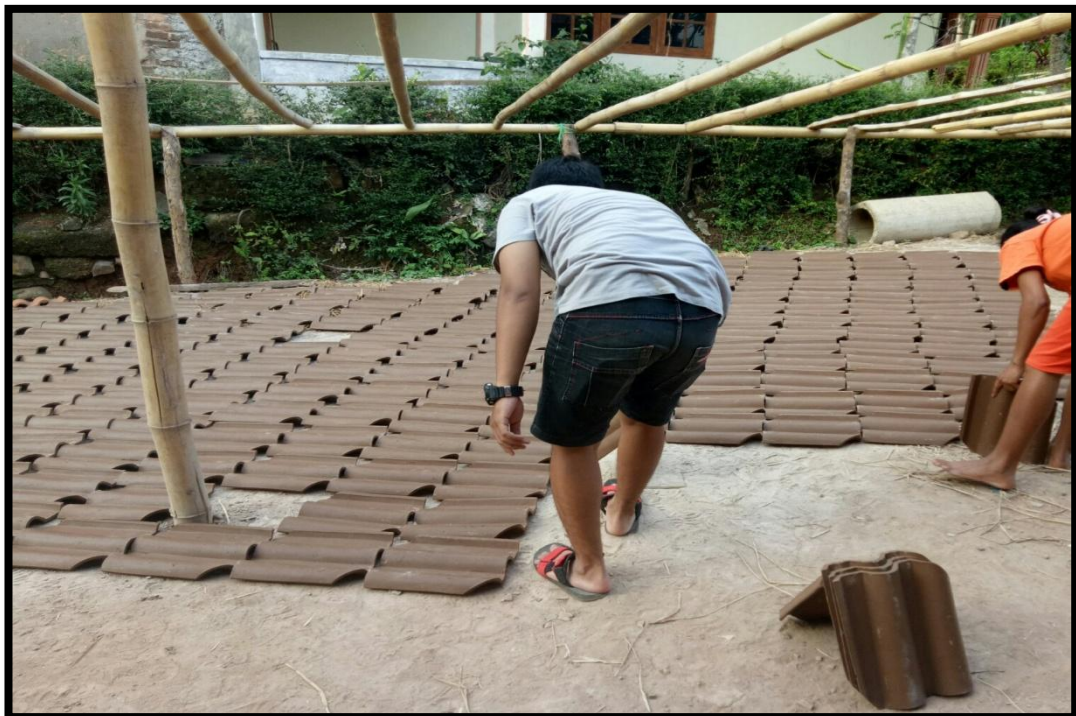
Gambar 3: Gambar diatas menunjukkan bahwa genteng dijemur sebelum genteng dibakar.
