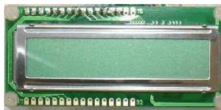
Gambar 2.5 Bentuk Fisik LCD Karakter 2x16
