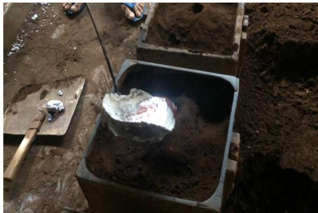
Gambar 3.23 Proses penuangan logam cair pada cetakan spesimen
