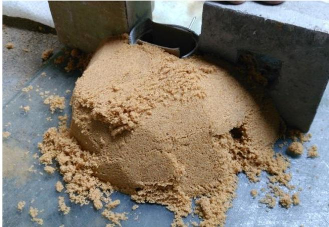
Gambar 3.18 Penempelan pasir silika ke piston
