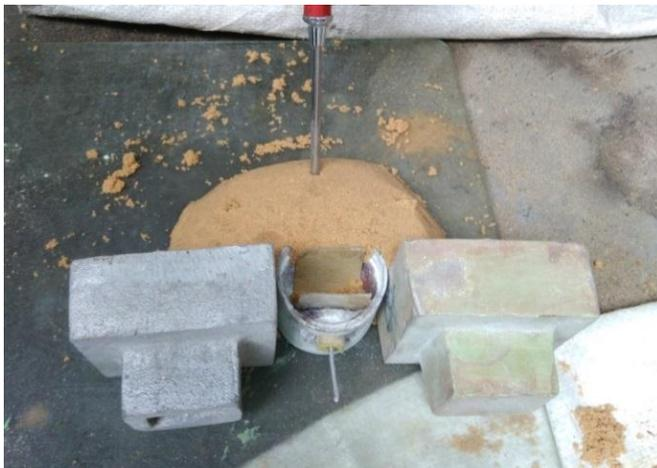
Gambar 3.19 Penyemprotan gas CO<sub>2</sub>
