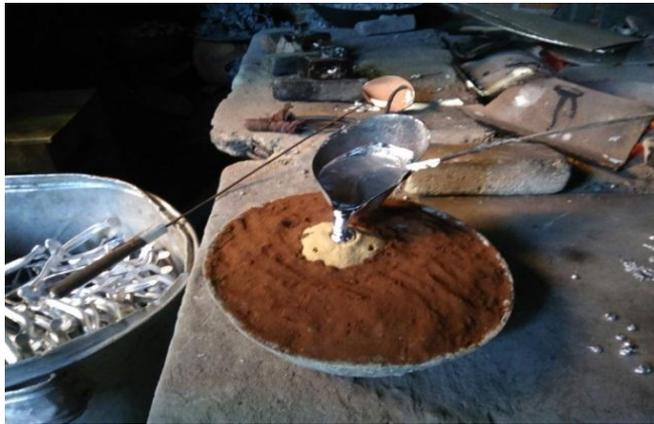
Gambar 3.22 Proses penuangan logam cair pada cetakan prototipe
