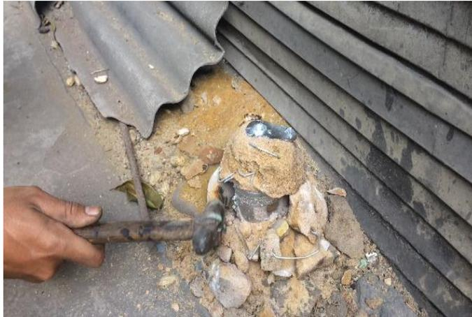
Gambar 3.24 Pelepasan Cetakan Prototipe
