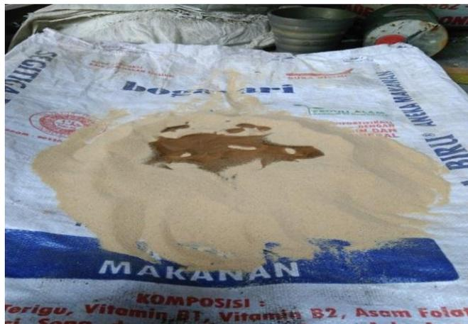
Gambar 3.17 Pencampuran pasir silika dengan water glass
