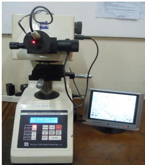
Gambar 3.8 Alat Uji *Vickers*
