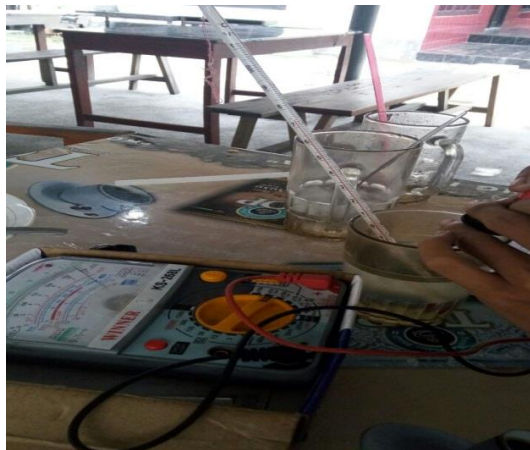
Gambar 4.4 Pemeriksaan tahanan IAT Sensor setelah di perbaiki
