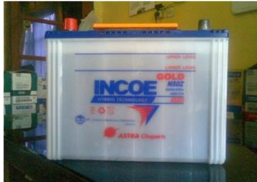
Gambar 3.6 ketinggian air baterai
