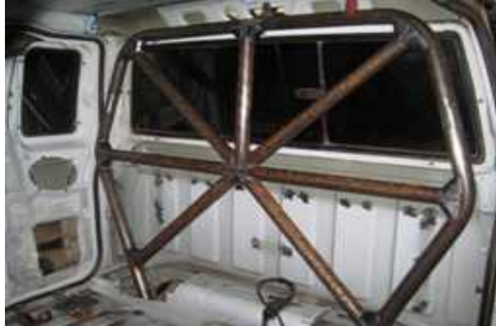
Gambar 2.12 Desain tubular dengan triangulasi ( FastnLow.net ).
