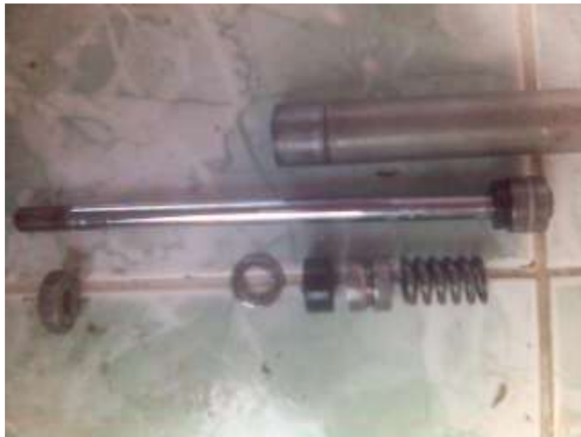
Gambar 4.12 Komponen dalam shock absorber http://spesialistsekokmoesmotor.blogspot.co.id
