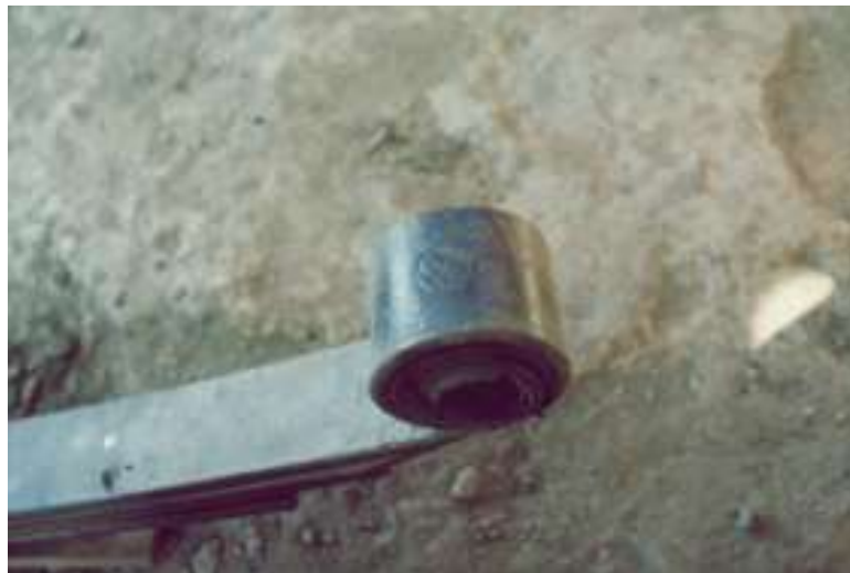
Gambar 4.6 letak karet bushing
