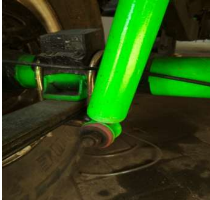
Gambar 4.17 letak karet bushing
