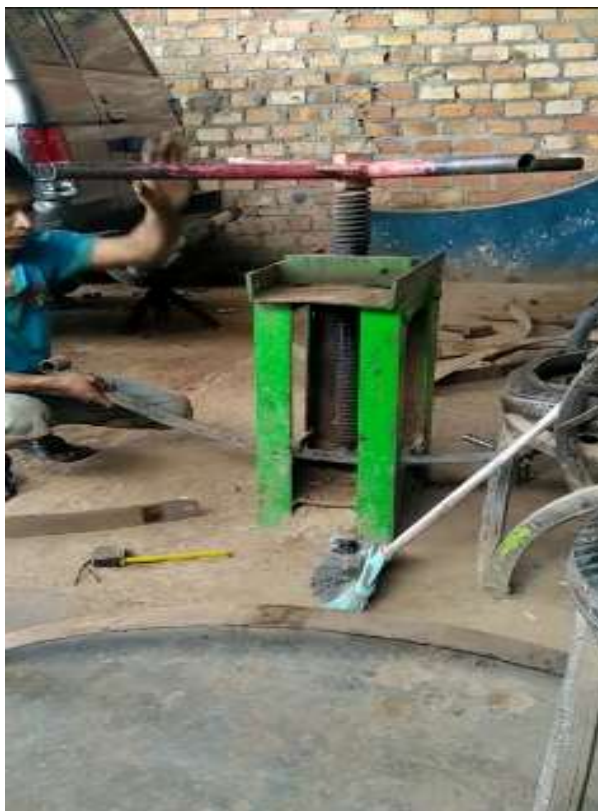
Gambar 4.3 Proses press lembar per daun
