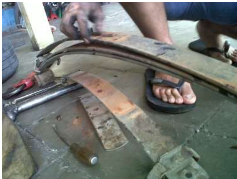
Gambar 4.5 Penyusunan lembar Per Daun
