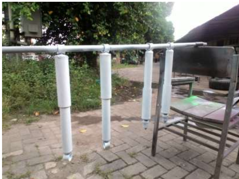
Gambar 4.18 Proses pengecatan warna dasar pada shock absorber
