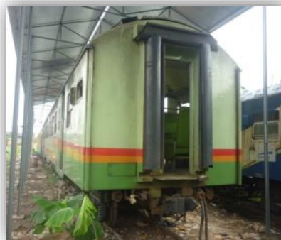
Gambar 2. 8b Pemanfaatan KRD yang dimodifikasi menjadi Kereta Kesehatan bertenaga penggerak sendiri
