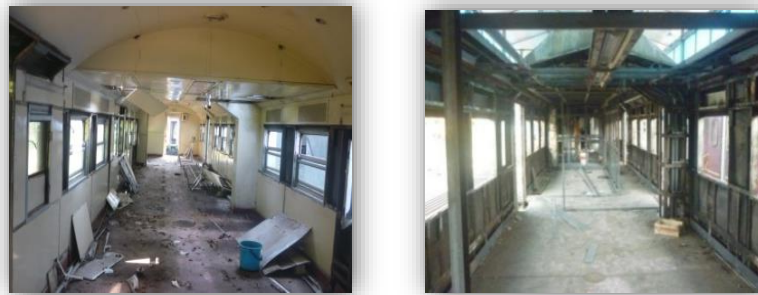
Gambar 2. 9 Pembokaran Interior untuk re-layout sesuai Design
