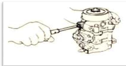
Gambar 3.15 Melepas *stator* (Memelihara/*service* sistem AC,
