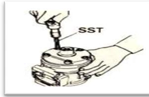
Gambar 3.30 Melepas baut pengunci (Memelihara/*service* sistem AC,
