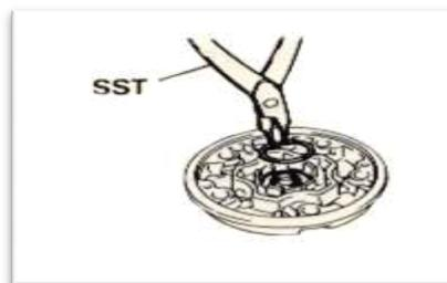
Gambar 3.35 Melepas *snapping* (Memelihara/*service* sistem AC,
