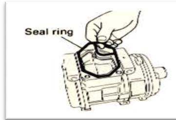
Gambar 3.46 Melumasi sil dengan oli (Memelihara/*service* sistem AC,
