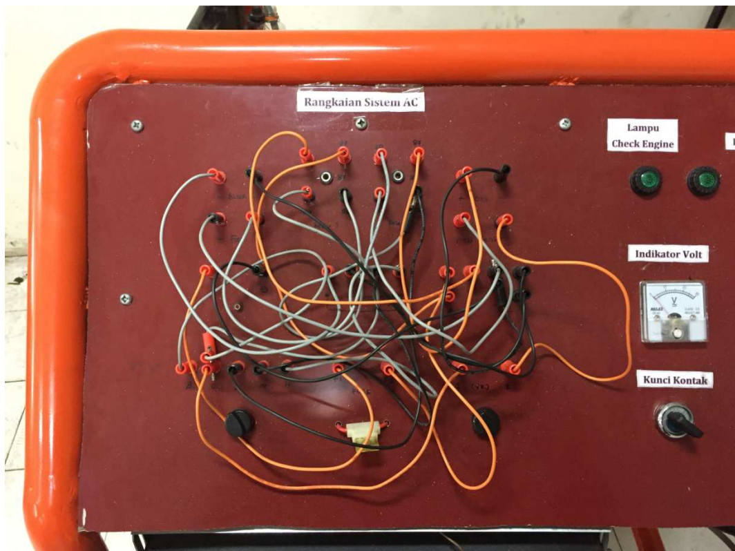
Gambar 6.10 Panel perakitan sistem kelistrikan AC
