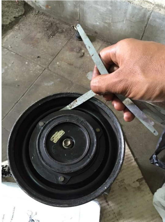
Gambar 6.7 Pengecekan celah kopling magnet
