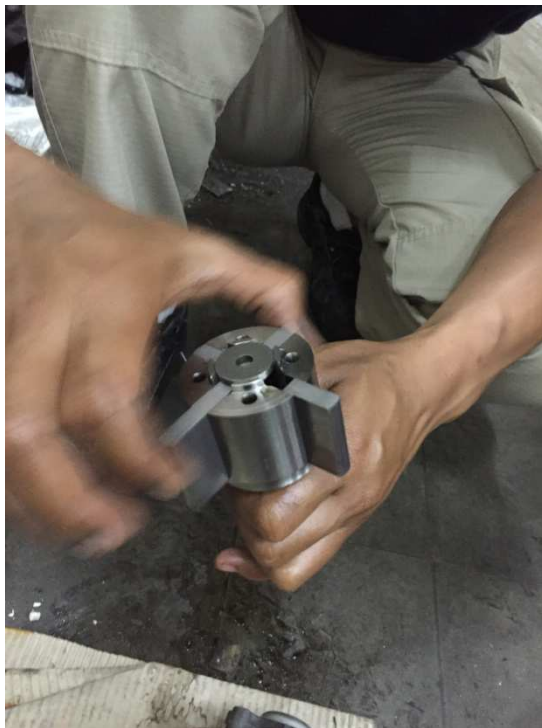
Gambar 6.4 Pemasangan bilah ( vane ) rotor
