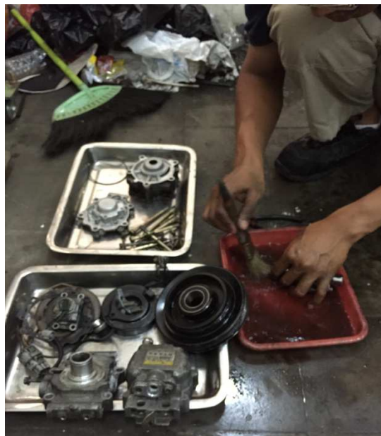
Gambar 6.2 Proses pencucian komponen kompresor
