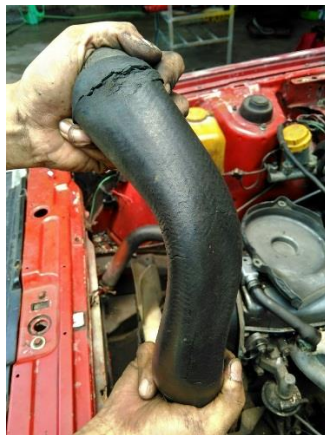
Gambar 4.2 (kiri) kondisi selang bagian atas dan (kanan) kondisi selang bagian bawah
