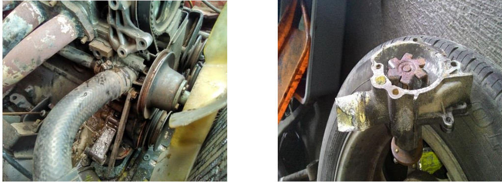
Gambar 4.5 Kondisi Waterpump (pompa air)
