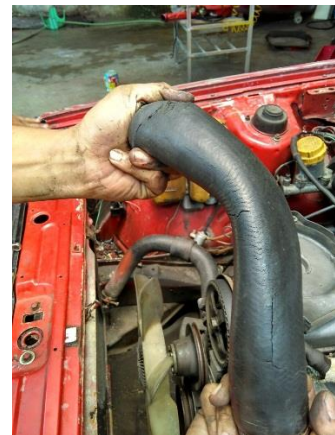
Gambar 4.2 (kiri) kondisi selang bagian atas dan (kanan) kondisi selang bagian bawah
