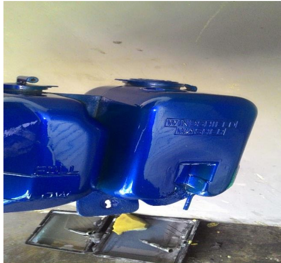
Gambar 3.32 reservoir tank atau tangki cadangan
