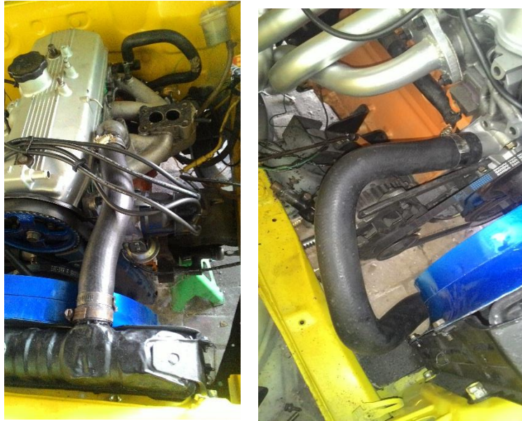
Gambar 3.36 Pemasangan Selang Radiator bagian atas dan bawah
