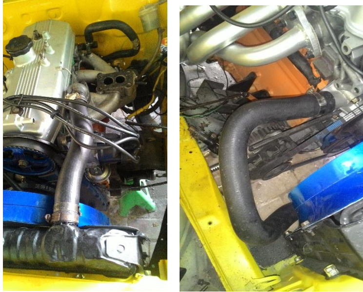
Gambar 3.15 Selang Radiator bagian atas dan bawah
