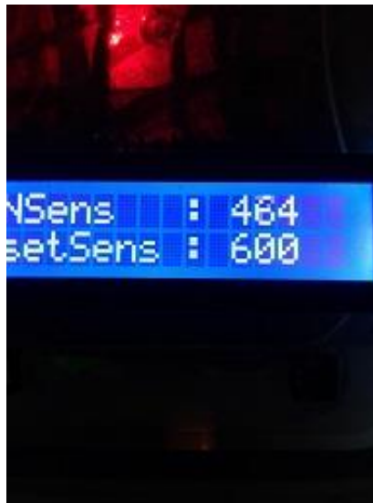
Gambar 4.33 Nilai Setting sensor jika wadah pakan terisi penuh.
