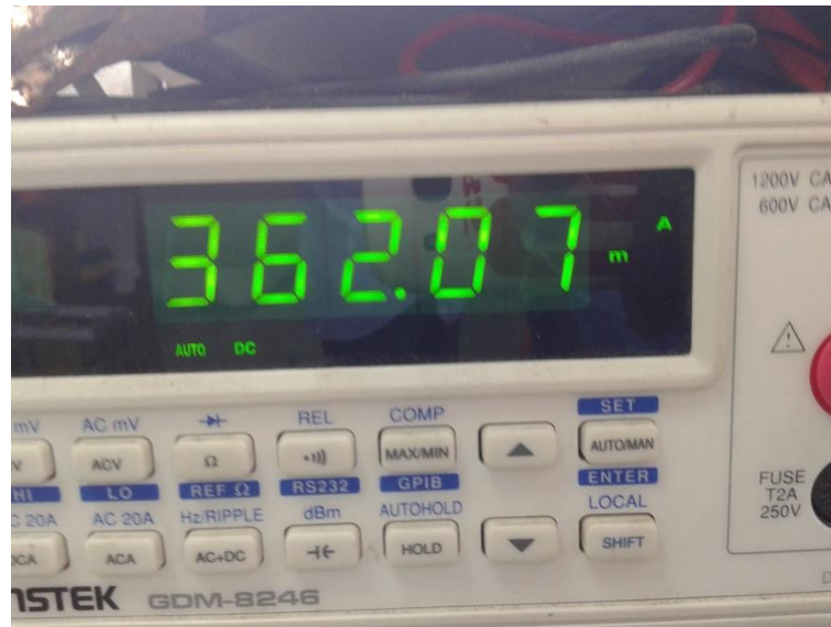
Gambar 4.37 Arus yang dihasilkan ketika motor DC menyala.
