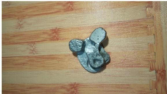
**Gambar 4.7 A.** Produk Dari Teknik *Sand Casting*.
