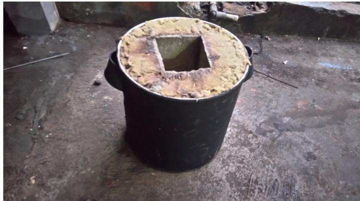
**Gambar 4.2** Bentuk Dapur Peleburan Logam Aluminium.
