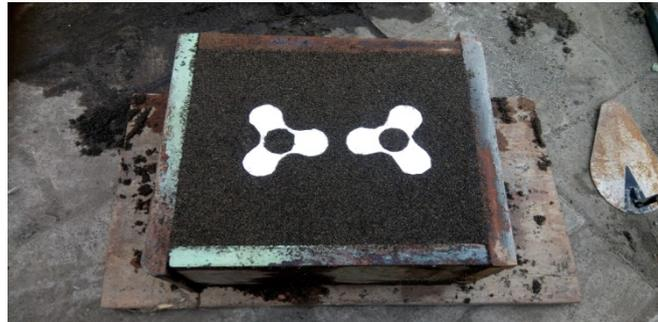
**Gambar 4.6** cetakan pasir satu sisi.
