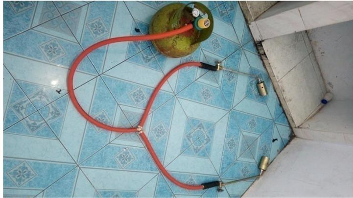
**Gambar 4.4** alat burner atau alat pembakaran
