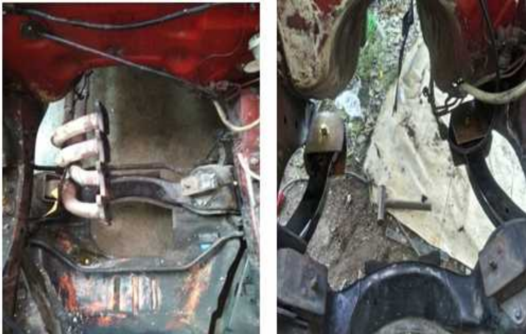
Gambar 4.18 Pemasanganudukan lower arm
