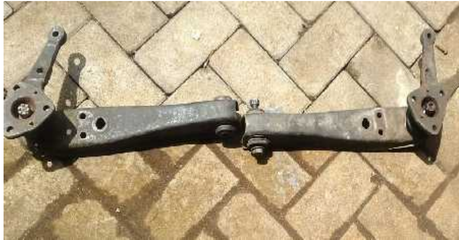
Gambar 4.9 Pemindahan kedudukan tie rod
