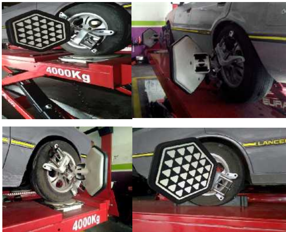
Gambar 4.27 Setelah dilakukan Spooing
