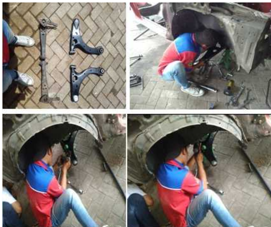
Gambar 4.16 Pemasangan Lower arm custom
