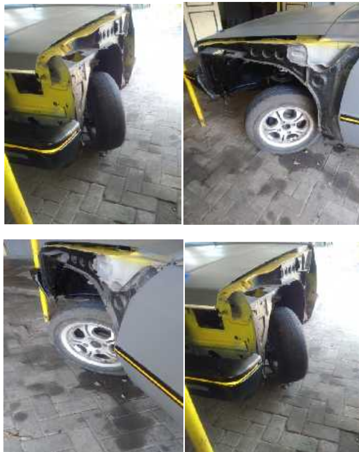
Gambar 4.29 Maksimal belok roda kiri
