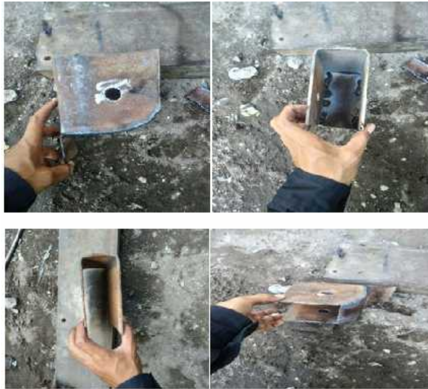
Gambar 4.17 Pembuatan dudukan lower arm
