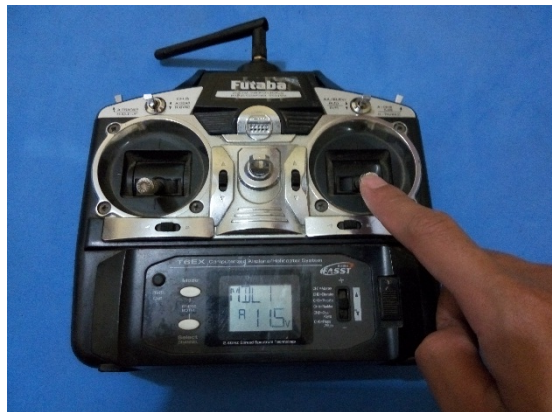
Gambar 4.8 posisi remote elevator ke bawah
