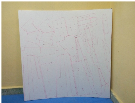
Gambar 3.4 menggambar desain ke polyfoam
