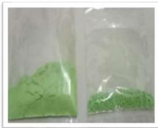
Gambar 4. 16 Obat pada *automatic* mortar yang telah melalui proses pengayakan
