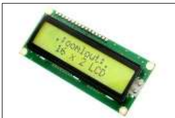
Gambar 2. 9 Bentuk fisik LCD 16x2 [8]
