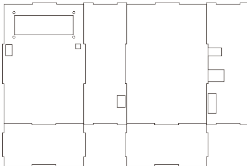
Gambar 3.8 Desain box modul Thermohygrometer
