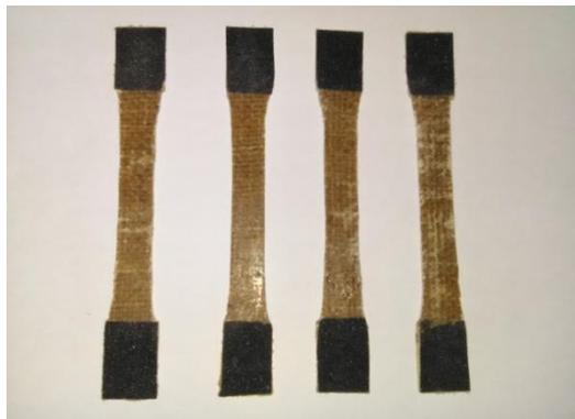
Gambar 4.3 uji spesimen *raw* material
