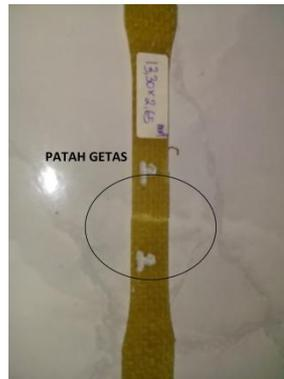
Gambar 4.9 Patahan spesimen uji tarik komposit
