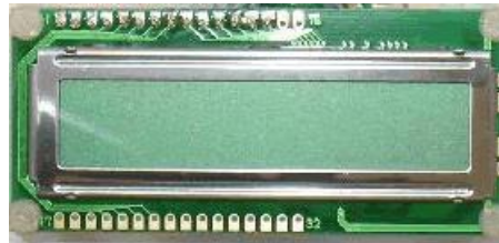
Gambar 2.5 Bentuk Fisik LCD Karakter 2x16[14]
