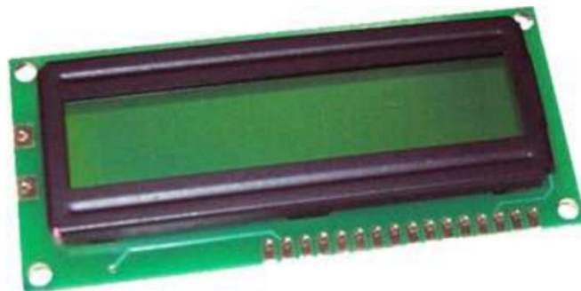
Gambar 2.4 LCD 2x16 karakter[8].
