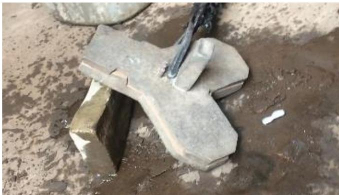
Gambar 3.4 Cetakan *Die Casting*
