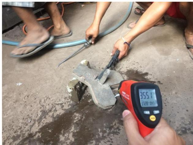
Gambar 3.26 Pengecoran Suhu 350°C
