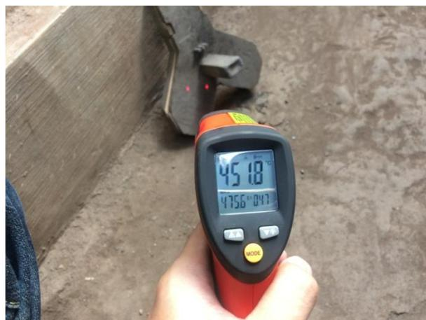
Gambar 3.27 Pengecoran Suhu 450°C
