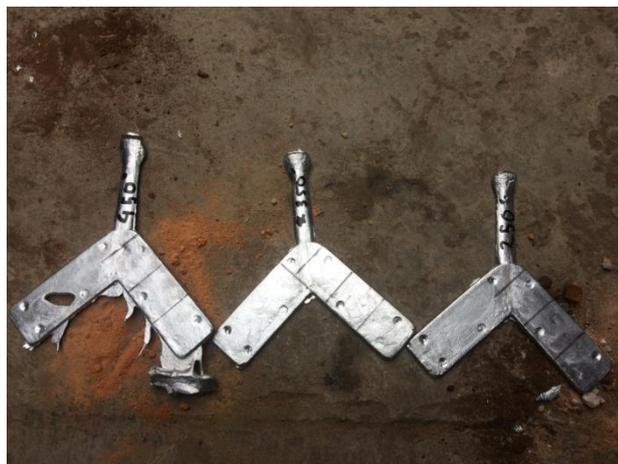
Gambar 3.29 Hasil Cetakan *Die Casting*
