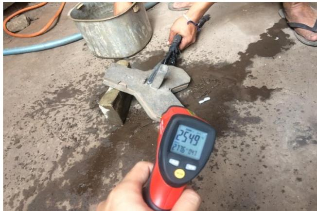
Gambar 3.25 Pengecoran Suhu 250°C
