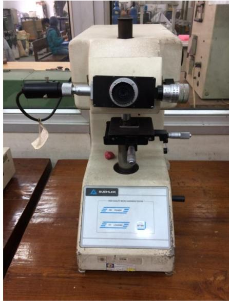
Gambar 3.14 Alat Uji *Vickers*
