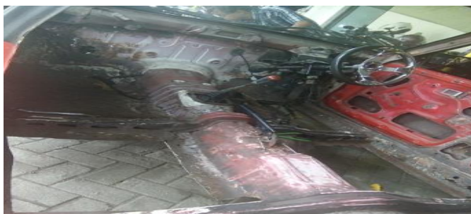
Gambar 4.5 Lantai Interior Sudah Dilakukan Pemotongan.
