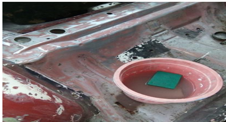
Gambar 4.6 Proses Pengamplasan Bagian Bodi Jok Belakang.
