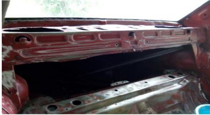
Gambar 4.7 Proses Pengamplasan Bagian Bodi Jok Belakang.
