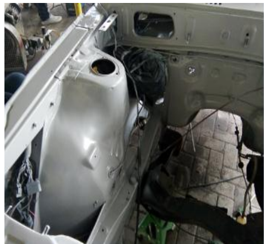
Gambar Kondisi Setelah Dilakukan Cat Dasar ( epoxy ) Pada Engine Buy .
