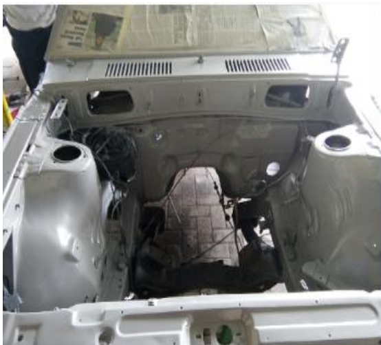
Gambar Kondisi Setelah Dilakukan Cat Dasar ( epoxy ) Pada Engine Buy .
