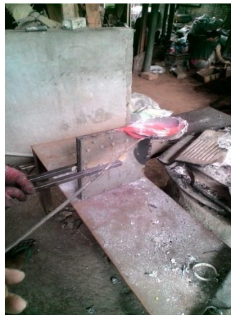
Gambar 4.5 penuangan logam kedalam cetakan.
