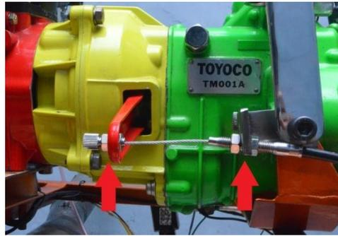
Gambar 4.5 Melepas unit kabel kopling
