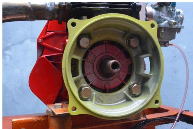
Gambar 4.16 Pemasangan *cover clutch* pada *crankcase*
