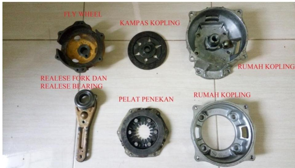
Gambar 4.3 komponen-komponen kopling kering mekanis
