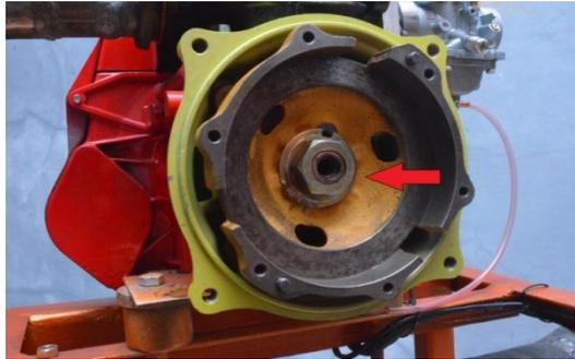
Gambar 4.17 Pemasangan *fly wheel*
