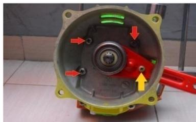
Gambar 4.19 Pemasangan unit pengungkit dan *clutch cover* pada transmisi
