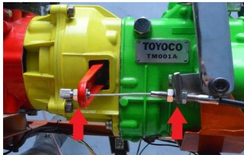
Gambar 4.21 Memasang kabel kopling
