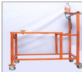
Gambar 3.2 Rangka *Engine Stand*
