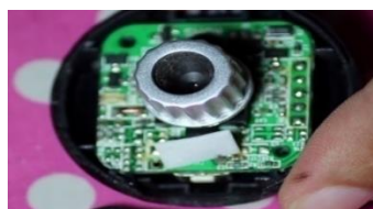
Gambar 4.7 Pemasangan kamera setelah dibongkar
