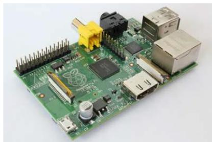
Gambar 2.10 *Raspberry Pi* tipe B
