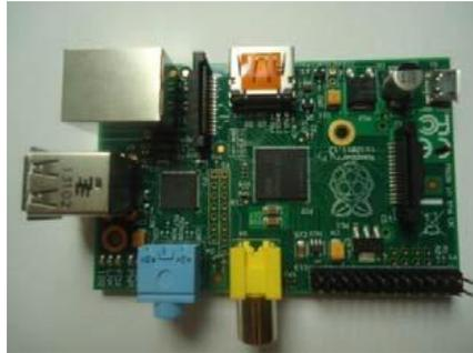
Gambar 2.8 Bentuk *Raspberry Pi*
