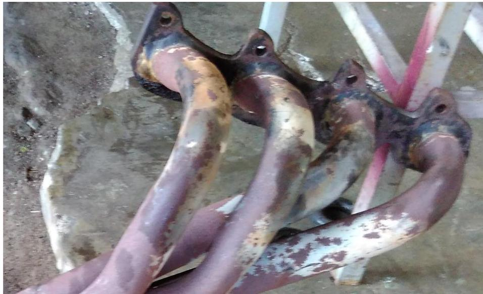
Gambar 4.4. Pipa Logam Header yang sudah berkarat
