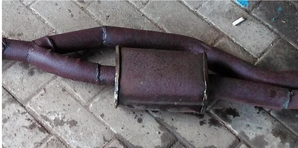
Gambar 4.5. Resonator sebelum dirubah
