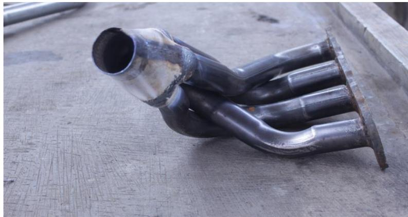
Gambar 4.9. Konfigurasi Header 4-1
