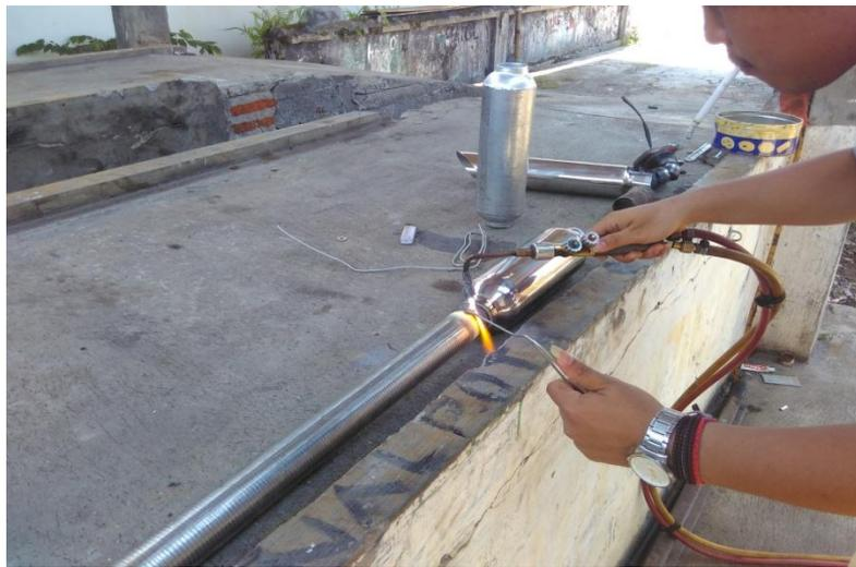
Gambar 4.13. Pengelasan Pipa
