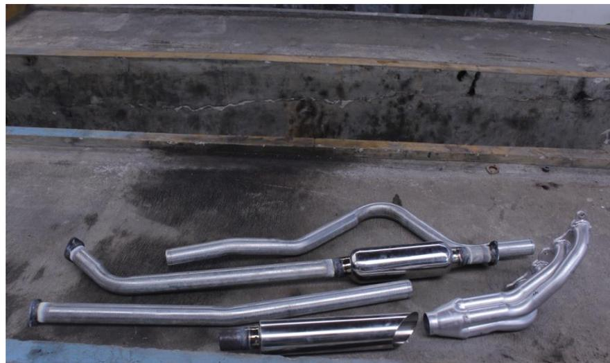
Gambar 3.18. Perancangan konfigurasi 4-1
