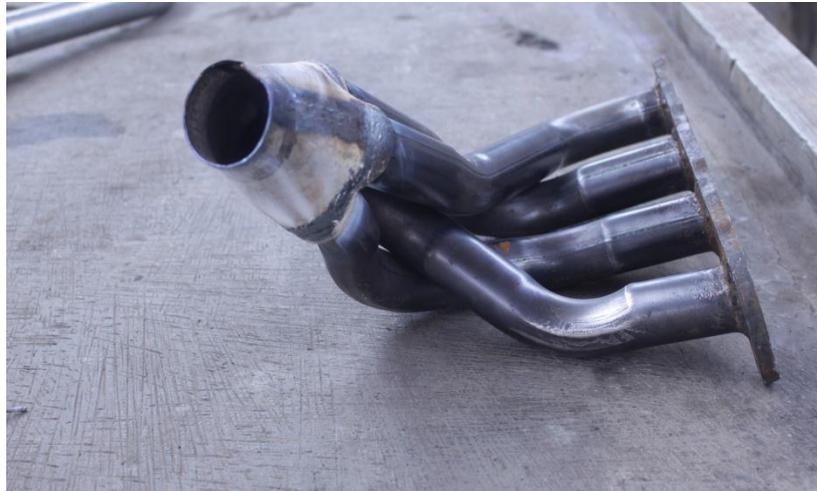
Gambar 2.13. Header Konfigurasi 4-1
