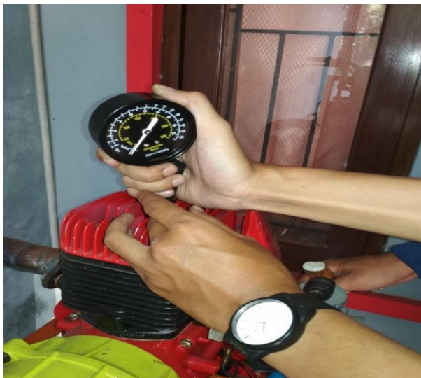
Gambar 4.23 Pengukuran tekanan kompresi ATV Toyoco G16ADP 2 Tak
