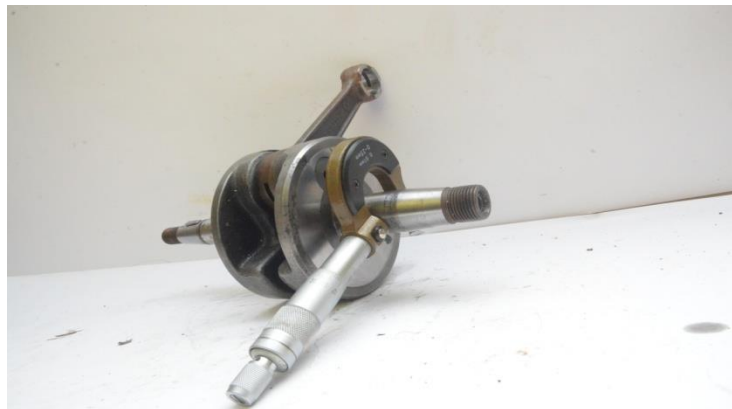
Gambar 4.10 Pengukuran poros engkol bagian depan ATV Toyoco G16ADP 2 Tak
