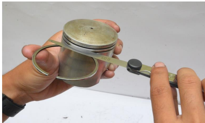
Gambar 4.12 Pengukuran ring kompresi 2 ATV Toyoco G16ADP 2 Tak
