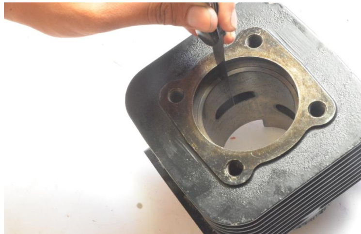
Gambar 4.22 Pengukuran celah ring piston ATV Toyoco G16ADP 2 Tak
