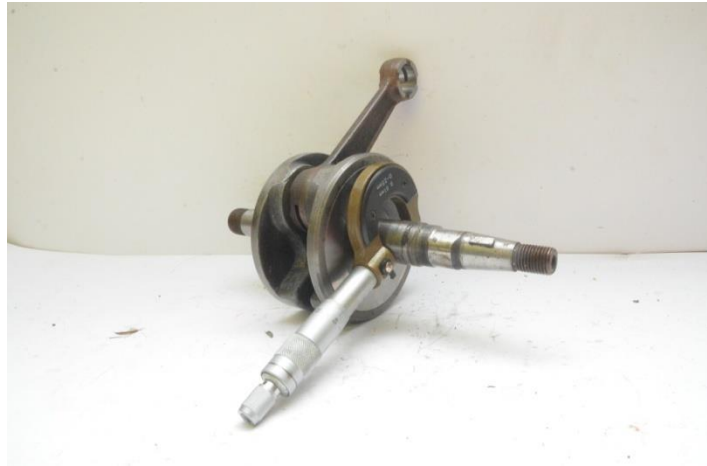
Gambar 4.9 Pengukuran poros engkol bagian belakang ATV Toyoco G16ADP 2 Tak
