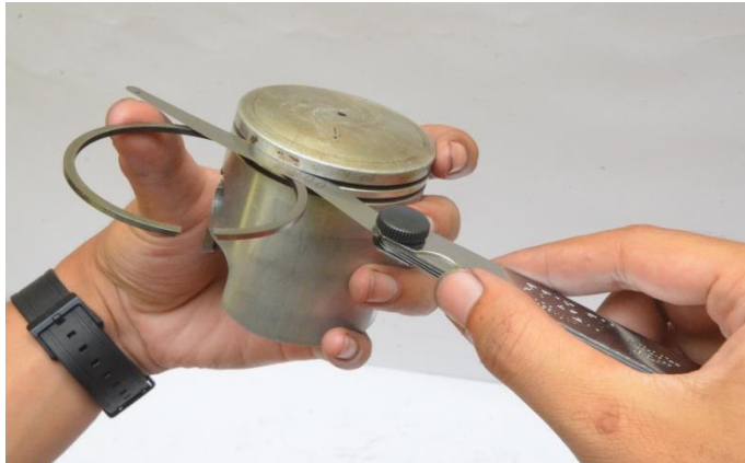
Gambar 4.11 Pengukuran ring kompresi 1 ATV Toyoco G16ADP 2 Tak
