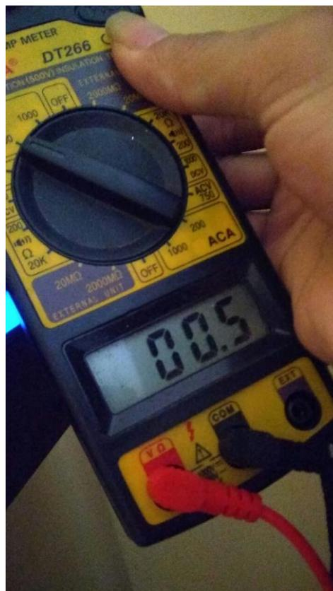
**Gambar 4.7** Pembacaan Arus Pada Multimeter Digital
