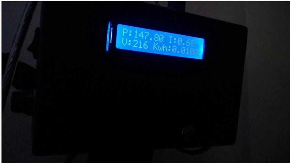
**Gambar 4.6** Pembacaan Arus Kwh Meter Siaga
