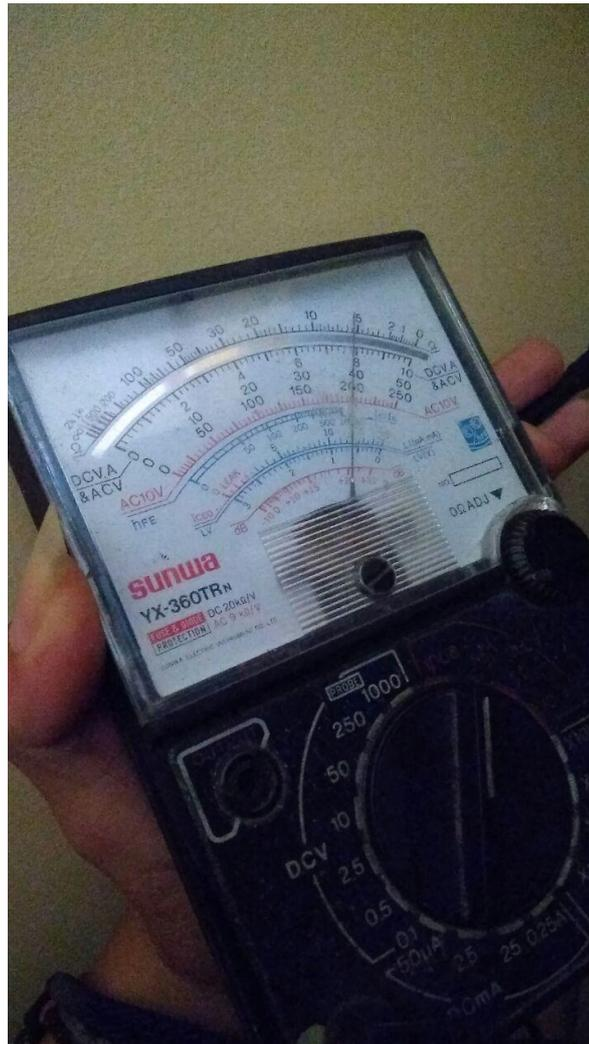
**Gambar 4.5** Pembacaan Tegangan Menggunakan Multimeter Analog
