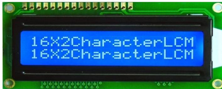
Gambar 2.4 Skematik LCD 2x16 [23]
