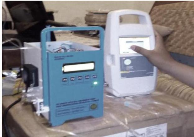
Gambar 4.2 Proses Pengujian Alat dengan Menggunakan IDA
