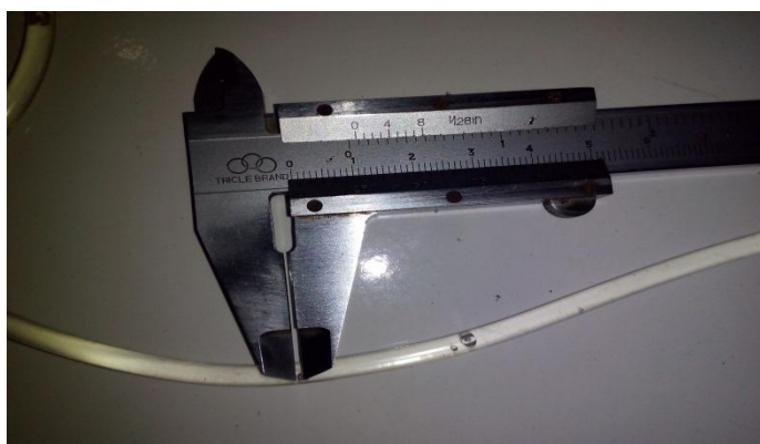
Gambar pengukuran diameter gelembung udara pada selang infus dengan hasil diameter gelembung 1 milimeter
