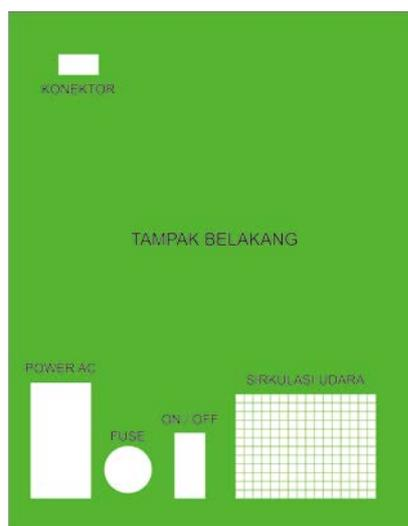
Gambar 3.4 Diagram mekanis alat tampak belakang
