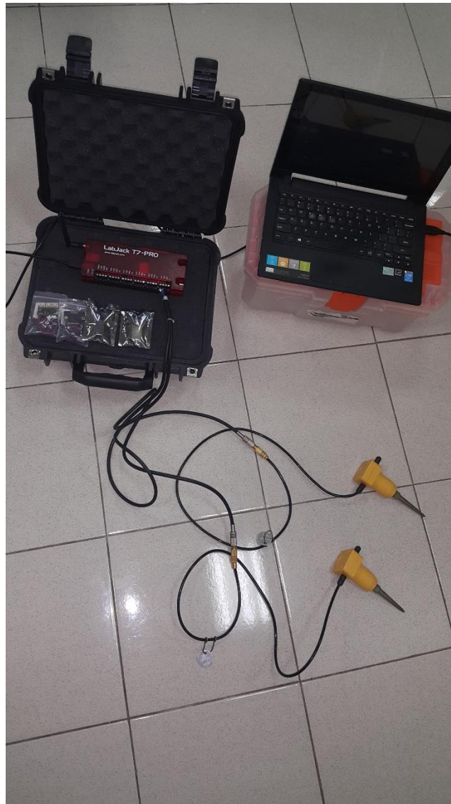
Gambar 5.1 Rangkaian instrumen ADC, sensor penerima gelombang dan penganalisis data yang digunakan dalam penelitian ini.
