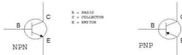
**Gambar 2.2** Lambang Transistor NPN dan PNP
