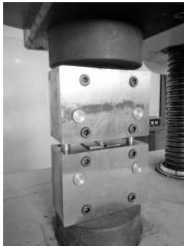
Gambar 4.6. Penjepitan spesimen untuk pengujian tekan.
