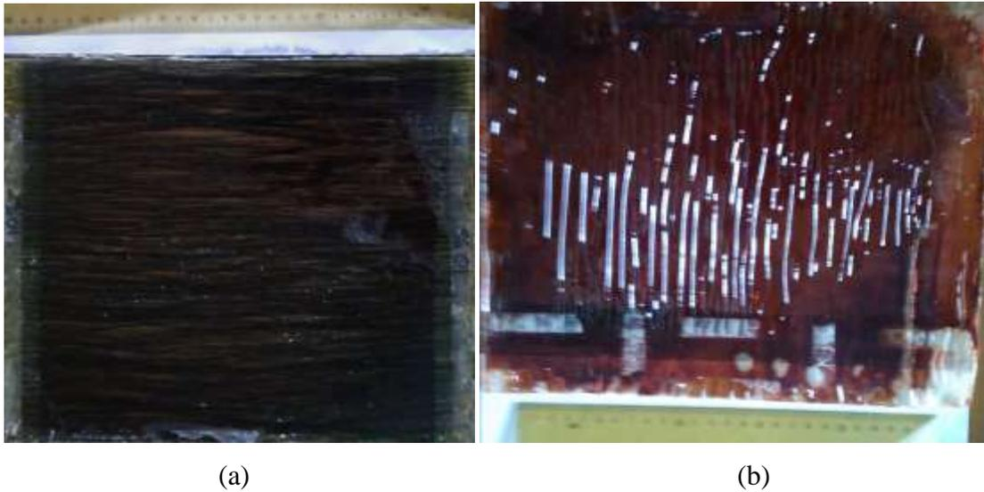
Gambar 4.4. Plat komposit serat ijuk/epoksi: (a)  $V_f = 10\%$ , (b)  $V_f = 0\%$ .
